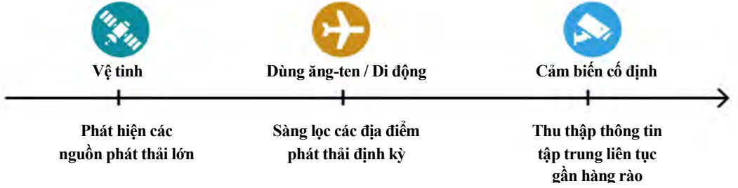
Hình 8.1. Các công cụ quan trắc khí mê-tan từ xa.
